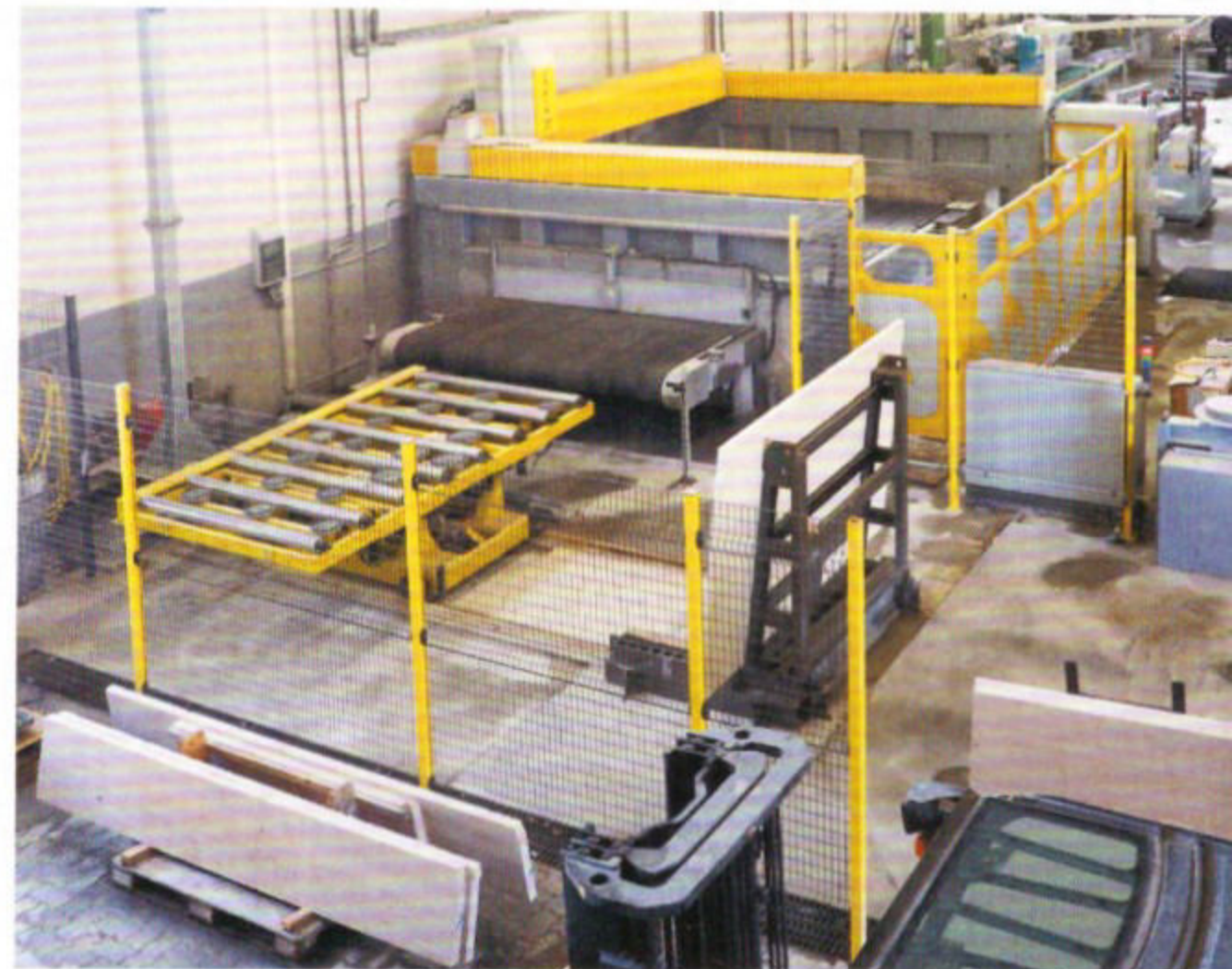
Mittlerweile unentbehrlich gewordener Geschwindigkeitsvorteil: Die 17 Meter lange, förderbandgetriebene Intra-Sägeanlage verfügt über eine automatische Beladestation
