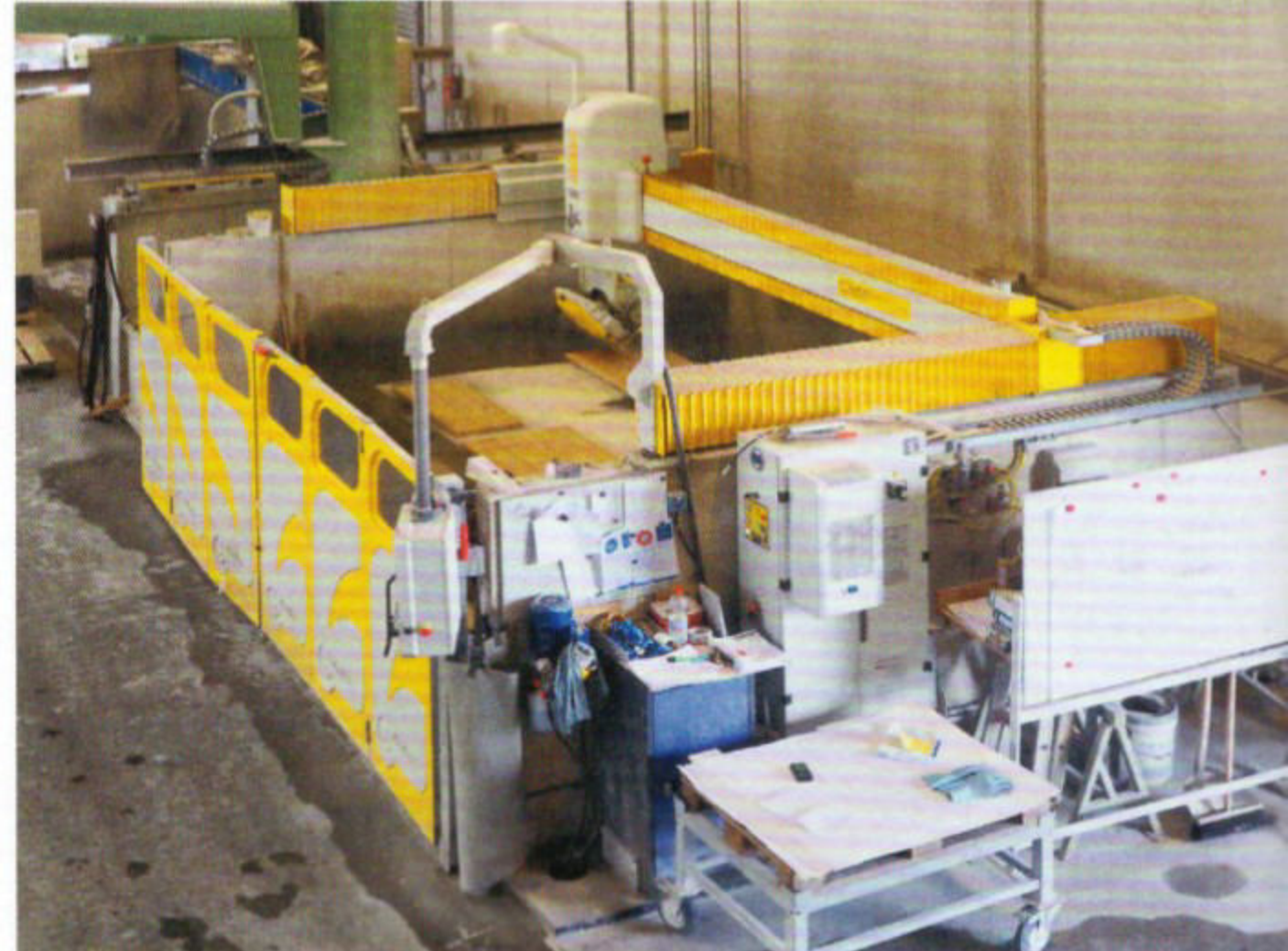
Auch bei der zweiten Säge der Firma Mühl, der Gmm Brio, handelt es sich um eine vollwertige fünfachsige CNC-Brückensäge mit Drehkopf
