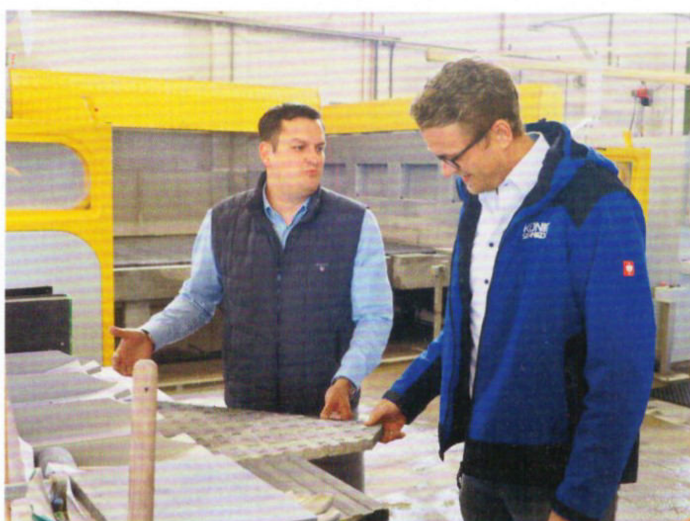
Eine der durch die Sägegenauigkeit erst möglich gewordenen Spezialanfertigungen: Lars Mühl zeigt Stephan Müller die in Betonwerkstein gesägten Blindenleitsysteme
