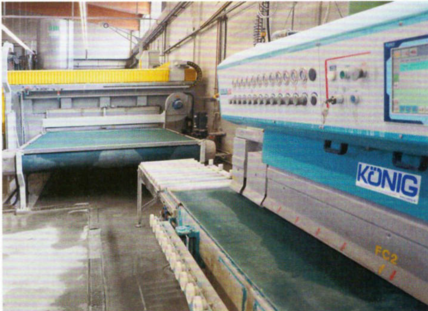
Bis zu 70 Rohplatten pro Tag: Von dem gewaltig gesteigerten Sägeausstoß ist die Kantenschleifmaschine überfordert und soll demnächst ersetzt werden
